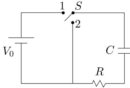
En el circuito de la figura se tiene una fuente de tensión  $V_0$ , una resistencia  $R$ , un interruptor  $S$  y un capacitor  $C$ . Inicialmente el capacitor está descargado y el interruptor está en posición neutra como se muestra en la figura.
