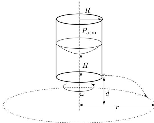
Un tanque cilíndrico de radio  $R$  contiene agua y gira sobre su eje con velocidad angular  $\omega$  constante. En un punto de su pared, muy cerca del fondo, se sitúa un pequeño orificio por el que sale líquido horizontalmente. La altura del líquido en el centro del tanque es  $H$ .
