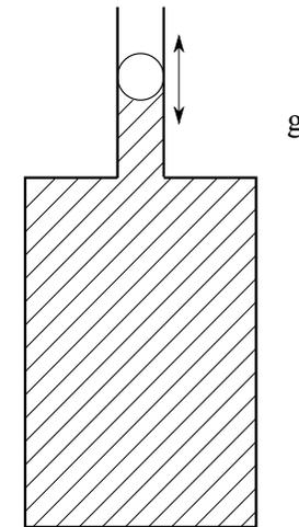
La figura muestra un recipiente cerrado herméticamente que contiene un gas ideal. Cerrando el tubo vertical que sale del recipiente se encuentra una esfera de masa  $M$  y radio  $R$  que puede deslizar sin rozamiento por el tubo. En el exterior del recipiente se encuentra aire a la presión atmosférica  $p_A$ . En equilibrio, el volumen total de gas encerrado es  $V_0$ . Cuando se altera levemente la posición de equilibrio de la esfera, la misma realiza pequeñas oscilaciones.
