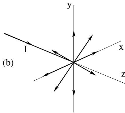
La corriente que circula por un cable recto (en la dirección  $z$ ) se divide en dos partes iguales al llegar a  $z = 0$ , como se indica en la figura (a). Los dos cables salientes están en el plano  $(x, y)$ , formando ángulos  $\theta$  y  $-\theta$  con respecto al eje  $y$ .
