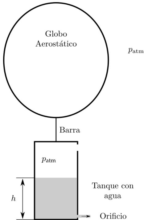
Un tanque cilíndrico de  $1\text{ m}$  de radio interior contiene agua hasta una altura  $h$ . Cerca del fondo del tanque se encuentra un pequeño orificio circular por el que puede salir horizontalmente un chorro de agua de radio  $1\text{ mm}$ .
