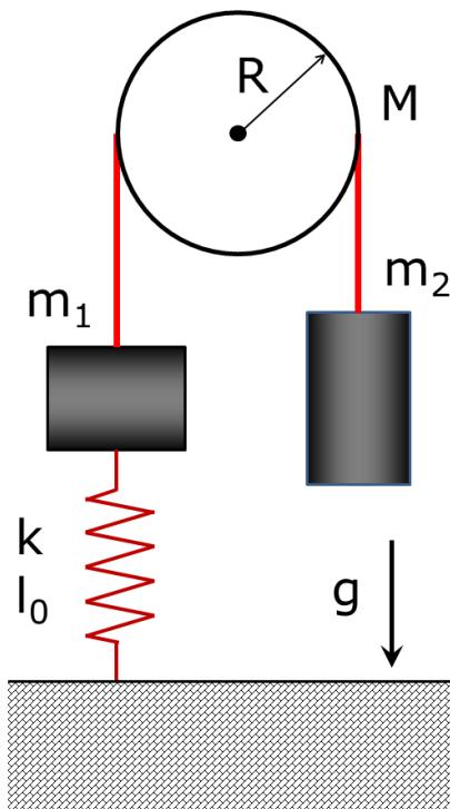
El montaje que se observa en la figura consta de una polea de masa  $M$  y radio  $R$ , una masa  $m_1$  a la izquierda, una masa  $m_2$  a la derecha, y un resorte de rigidez  $k$  y longitud en reposo  $l_0$ . La cuerda sin masa que une  $m_1$  y  $m_2$  no desliza en la polea ni cambia de longitud.
