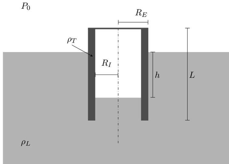
Considerar un tubo cilíndrico de sección circular y longitud  $L$ , de radio externo  $R_E$  y radio interno  $R_I$ , fabricado con un material homogéneo de densidad  $\rho_T$ . El tubo se encuentra tapado en su extremo superior, con una tapa de masa despreciable, e inicialmente está lleno de aire a presión atmosférica,  $P_0$ . Se introduce en un líquido de densidad  $\rho_L$  hasta quedar en equilibrio, como se muestra en la figura.
