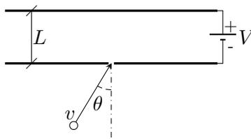
Dos placas planas paralelas, situadas a distancia  $L$  una de la otra, se mantienen a una diferencia de potencial  $V$  por medio de una batería, como muestra la figura. Por un pequeño orificio practicado en la placa de abajo ingresan electrones (de masa  $m$  y carga  $-e$ ), con velocidad  $v$  y formando un ángulo  $\theta$  con la dirección perpendicular a la placa. Una pantalla fluorescente en la placa de arriba permite determinar dónde inciden los electrones.
