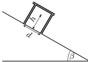
Un banquito se encuentra en reposo sobre una pendiente de ángulo  $\beta$ . Sus patas están separadas por una distancia  $d$  y su centro de masa se encuentra equidistante de ambas, a altura  $h$ . El coeficiente de rozamiento estático entre las patas y la superficie de la pendiente es  $\mu$ .
