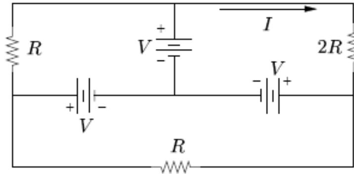
Además de los resistores que se observan en el diagrama, cada una de las baterías tiene una resistencia interna de  $1 \Omega$ . Si  $V = 10 \text{ V}$  y  $R = 10 \Omega$ , entonces la corriente  $I$ , medida en amperios es:
